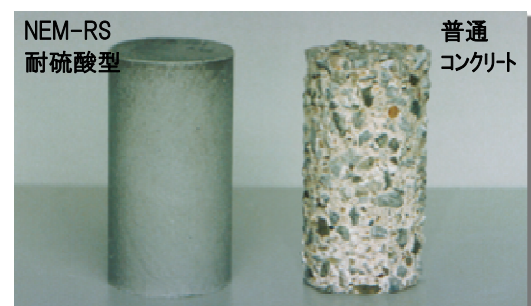
5%硫酸(pH 0.3~0.4)に30日浸漬した後の供試体表面
